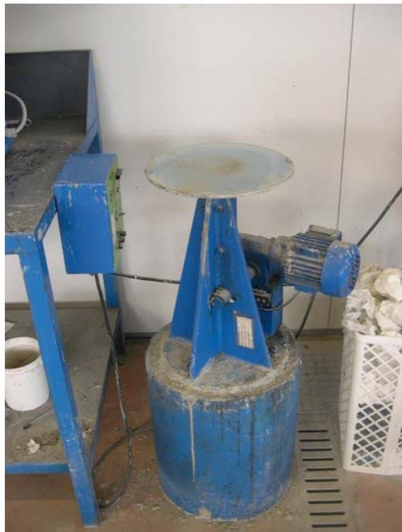
Fig. 2 - Mortar flow table (UNI 7044).
